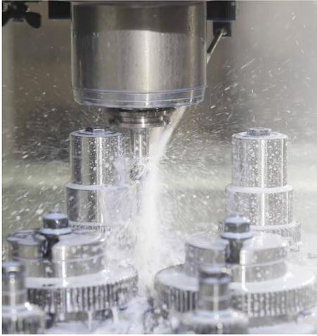
HAAS的12,000rpm主轴,由电机通过直联形式直接驱动主轴,能有效的减少振动、噪音和发热。30匹马力的矢量驱动系统提供了足够强大的低转速扭矩,并且同时也能满足高速加工所需的速度。
