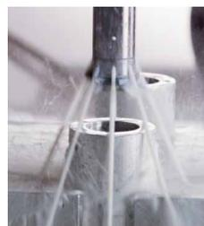
如果切屑重新进入切削区域会使得刀具加速磨损,不但会严重影响刀具的切削寿命,还会导致表面光洁度不良,最坏的情况还会使得零件或刀具报废。为了有效地清除切削区域的切屑,我们提供了一系列高效的解决方案。例如**主轴中心出水、中心吹气系统,以及节油型油雾润滑系统等。**
