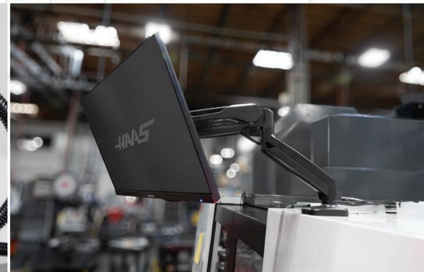
El sistema de cámara y monitor permite ver la pieza de trabajo y los procesos de mecanizado desde fuera de la máquina. El sistema está compuesto por una cámara totalmente hermética que se monta dentro del cerramiento de la máquina y un monitor LCD montado fuera y cerca del control que muestra el avance. La base magnética simplifica la colocación de la cámara y permite el montaje casi en cualquier lugar dentro del cerramiento.
