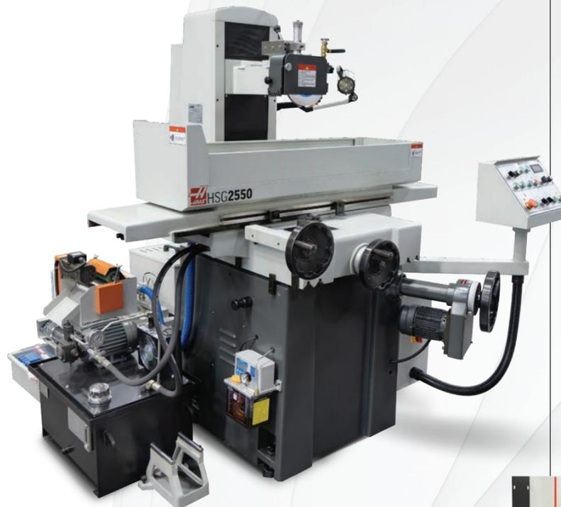
La rectificadora de superficies automática HSG2550 proporciona superficies con rectificado de precisión con tamaños y acabados críticos. Incorpora un rectificado de 200 mm de diámetro x 20 mm de ancho y un plato de garras electromagnético de 250 x 500 mm.
