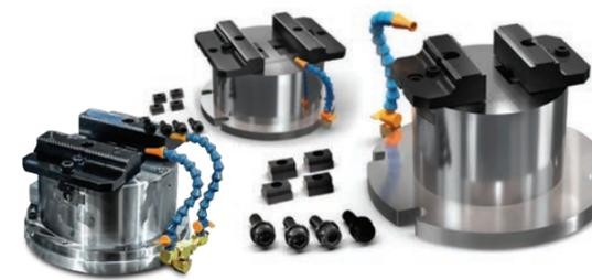
Nuestros tornos de banco hidráulicos están diseñados para simplificar y automatizar el amarre de pieza en nuestros centros de mecanizado universales de 5 ejes de Haas. Hemos dotado a las mordazas de torno de banco intercambiables con un plato hidráulico estacionario de 2 garras para crear un torno de banco autocentrante versátil, que pueda activarse directamente desde el control de Haas.
