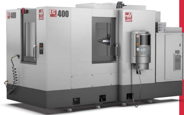
L'EC-400 a été conçu à partir de zéro avec des pièces coulées optimisées pour FEA pour une rigidité accrue et de meilleures performances de coupe dans un encombrement au sol compact. Il est doté d'un diviseur 4e axe continu pour un mouvement synchrone et est disponible avec un changeur d'outils de 100 logements pour une production à volume élevé. Découvrez comment les ingénieurs Haas ont fait passer notre dernier CUH au niveau supérieur.
