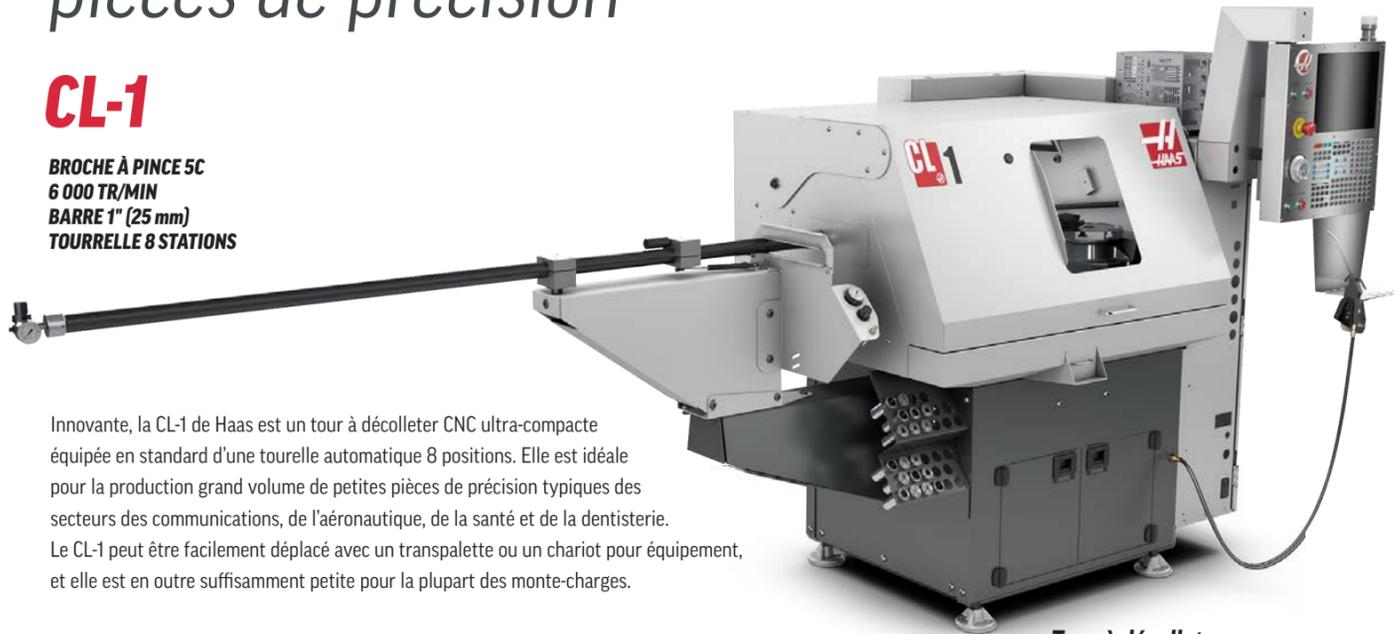
Innovante, la CL-1 de Haas est un tour à décolleter CNC ultra-compacte équipée en standard d'une tourelle automatique 8 positions. Elle est idéale pour la production grand volume de petites pièces de précision typiques des secteurs des communications, de l'aéronautique, de la santé et de la dentisterie. Le CL-1 peut être facilement déplacé avec un transpalette ou un chariot pour équipement, et elle est en outre suffisamment petite pour la plupart des monte-charges.
