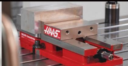
**DISPOSITIF DE SERRAGE DE LA PIÈCE POUR FRAISEUSE**
