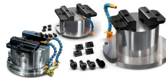
Nos étaux hydrauliques ont été conçus pour simplifier et automatiser le dispositif de serrage de la pièce sur les centres d'usinage universels Haas à 5 axes. Les mors d'étau amovibles sont utilisés sur les mandrins fixes/hydrauliques à 2 mors pour obtenir des étaux auto-centrants polyvalents et activables directement depuis la commande Haas.
