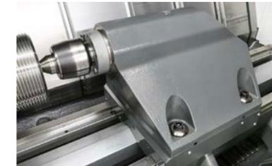
**Le fourreau de poupée mobile** Cette option adapte la poupée mobile programmable d'un cône morse MT5 à un cône morse MT6, permettant l'utilisation de pointes tournantes MT6 plus grandes. Le cône plus grand fournit un soutien et une capacité de poids supérieurs pour les applications de poupée mobile exigeantes.
