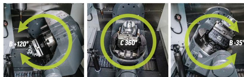
Courses sur l'axe B et l'axe C à passage rotatif, illustrées avec l'étau autocentrant et l'élevateur Haas
