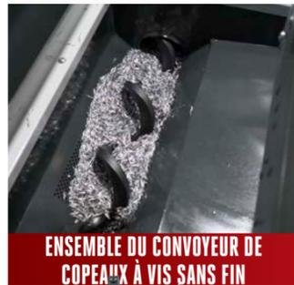
ENSEMBLE DU CONVOYEUR DE COPEAUX À VIS SANS FIN
