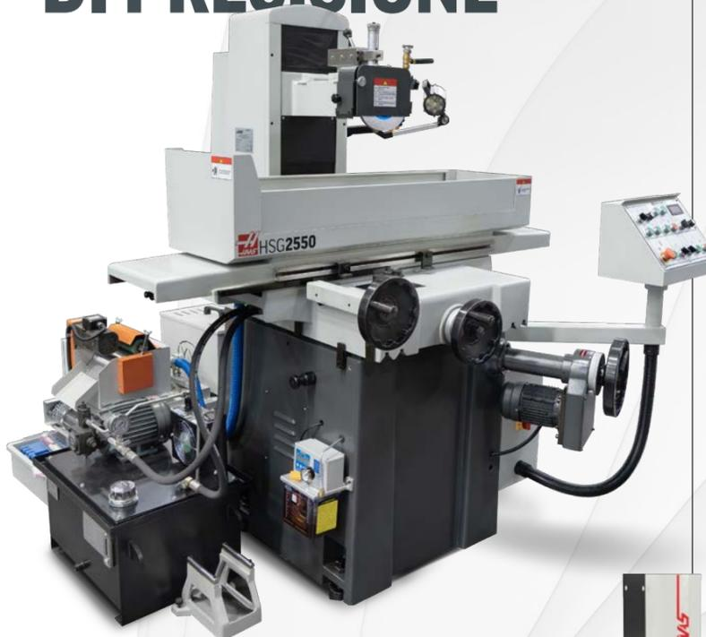
La smerigliatrice di superficie automatica HSG-2550 fornisce superfici rettificate di precisione per dimensioni e rifiniture critiche. Include una mola da 200 mm di diametro x 20 mm di larghezza e un mandrino autocentrante elettromagnetico da 500 x 250 mm.
