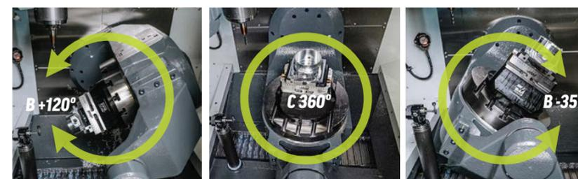
**Rotazione della tavola rotante** Corse dell'asse B e dell'asse C, mostrate con morsa autocentrante e montante Haas
