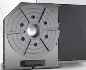
Il mandrino dell'asse B articolato della VP-5 fornisce una rotazione da +106° a -8°, consentendo di lavorare pezzi prismatici in una predisposizione singola. Sincronizza il movimento dell'asse B con gli assi X, Y e Z per la lavorazione interpolata 3D o attiva il potente freno dell'asse B per una lavorazione rigida 3+1.
