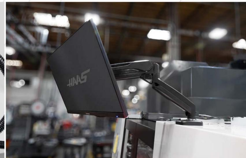
Il nostro sistema di monitoraggio con telecamera consente di visualizzare il pezzo da lavorare e i processi di lavorazione, dall'esterno della macchina. Il sistema comprende una telecamera completamente chiusa, montata all'interno dell'involucro della macchina, e un monitor LCD montato all'esterno, vicino al controllo, che visualizza i feed della telecamera. Una base magnetica semplifica il posizionamento della telecamera e consente il montaggio quasi ovunque all'interno dell'involucro.
