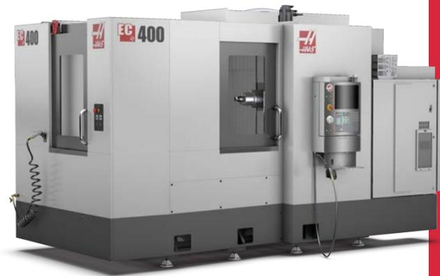
L'EC-400 è stato progettato da zero con pezzi fusi ottimizzati per FEA per una maggiore rigidità e migliori prestazioni di taglio in una pianta compatta. È dotato di un sistema rotante per il 4° asse in continuo per il movimento sincrono ed è disponibile con un cambio utensile a 100 tasche per la produzione di grandi quantità. Guarda come gli ingegneri Haas hanno portato i nostri nuovi HMC al livello successivo.
