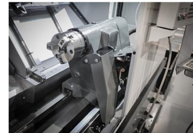
**Adicione um sub-spindle para combinar operações. Também disponível em modelos de eixo Y.**
