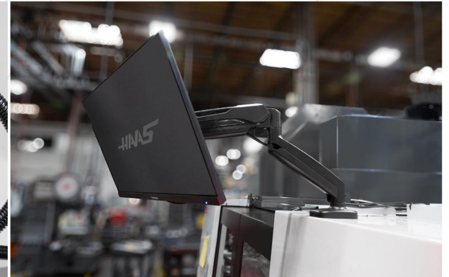
O nosso sistema de monitorização da câmara permite-lhe ver a sua peça de trabalho e os processos de maquinagem – a partir do exterior da máquina. O sistema inclui uma câmara totalmente fechada que é montada no interior da caixa da máquina e um monitor LCD montado no exterior, perto do controlo, que apresenta o avanço da câmara. Uma base magnética simplifica a colocação da câmara e permite a montagem quase em qualquer lugar dentro do compartimento.
