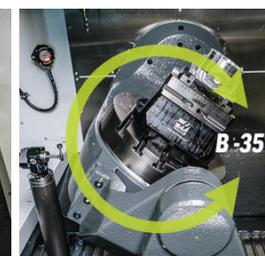
**Rotativa de oscilação** Percursos de eixo B e eixo C, mostradas com a prensa e o elevador autocentrantes Haas
