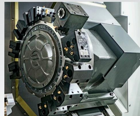
As torretas BMT fornecem uma conexão mais rígida dos suportes de ferramentas à torreta, fornecendo melhores acabamentos de superfície e cortes mais precisos.
