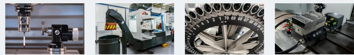
SYSTÈME DE PALPAGE SANS FIL    SYSTÈME D'ÉVACUATION DES COPEAUX    CHANGEUR D'OUTILS 70 POSITIONS    SERRAGE DE PIÈCES AUTOMATISÉ
